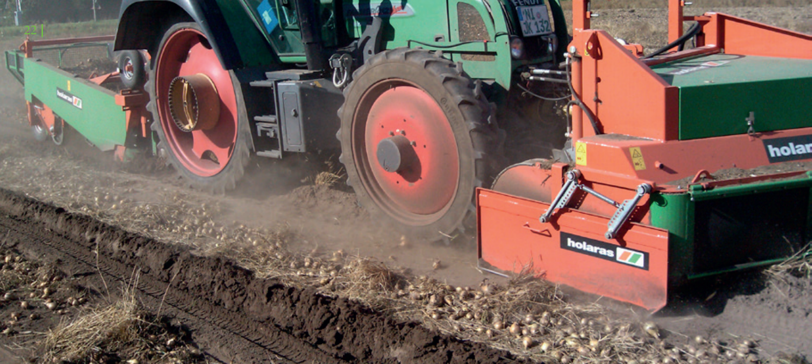
Zwiebelernte mit Krautschläger im Frontanbau und Siebkettenroder im Heckanbau
